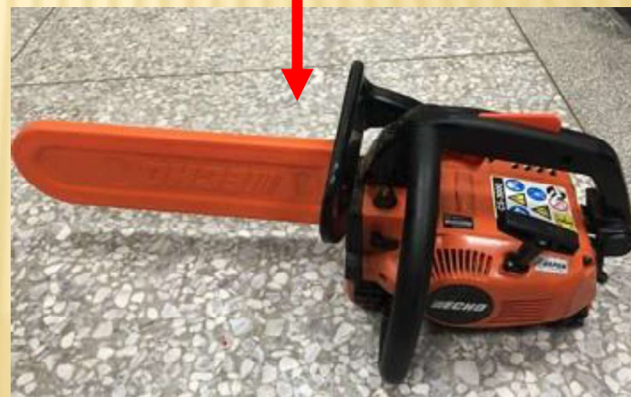
鏈鋸 (型號CX-3000)：重量 3.4 kg，長 260mm 寬 230mm 高 220mm，鋸切長度 300mm。
