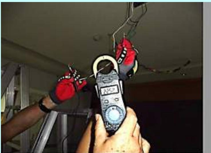
該照明設備之手捺開關關閉後，照明設備其中 1 條電源線路仍有帶電 225V
